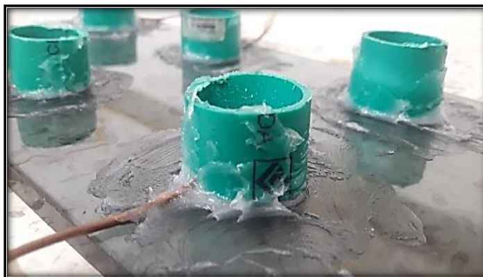
Figura 22. Montaje de las probetas para estudio electroquímico
