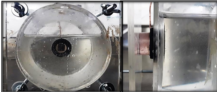
Figura 27. Montaje de probeta en celda electroquímica.
