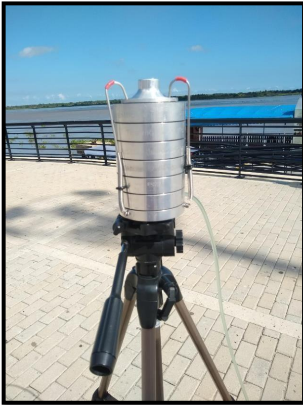
Anexo 15: Impactador de Cascada de seis etapas. Andersen. Fuente: (De Moya.H.I. 2019)
