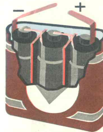
Pilas secas. Batería de tres pilas
