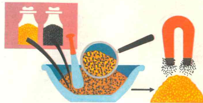
El azufre y las limaduras de hierro se mezclan; después se pueden separar valiéndose de un imán
