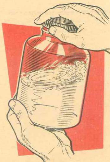
F. 36. — La lechada de cal se enturbia en presencia del gas carbónico.
