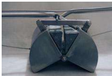
Figura 1. Draga empleada para la toma de sedimento superficial. Marca ecodym
